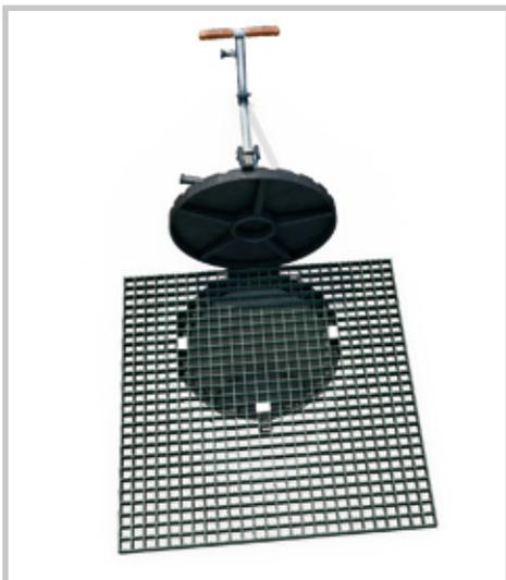
La griglia anticaduta "Grid" previene la caduta accidentale di cose e/o persone all'interno dei tombini oggetto di ispezione. È realizzata con un materiale plastico rinforzato con fibre di vetro (PRFV): leggero e molto resistente. Non richiede alcun tipo di manutenzione ed è comodamente trasportabile all'interno di qualsiasi automezzo. È disponibile in quattro dimensioni e viene fornita con 4 fermi anti-traslazione.
